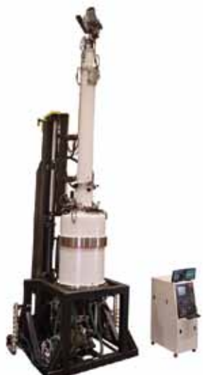
Crystal Puller for Monocrystalline Silicon Ingots (Kayex)
